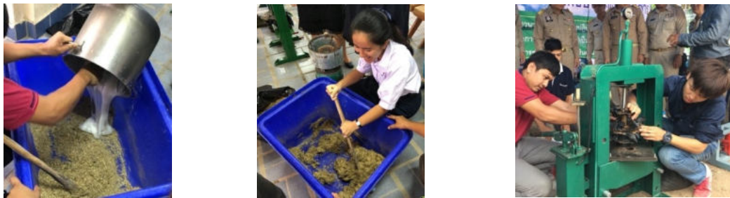
ก. เทกาวแป้งเปียกลงถึงผสม ข. ผสมกาวแป้งเปียกกับวัสดุให้เป็นเนื้อเดียวกัน ค. นำวัสดุที่ผสมใส่ในแม่พิมพ์และอัดขึ้นรูป
