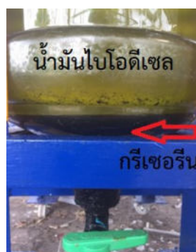
ภาพที่ 3 เกิดการแยกชั้นระหว่างกลีเซอร์ลินกับน้ำมันไบโอดีเซล
