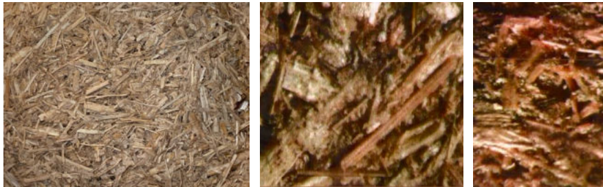
ภาพที่ 6 โครงสร้างกระถางชีวภาพของการทดลองที่ A22 ที่อัตราส่วนของวัสดุ 2:1:1:1
