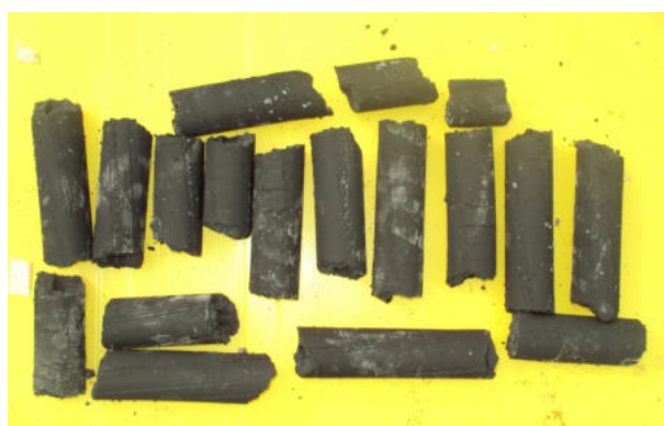
ภาพที่ 5 ถ่านอัดแท่งที่ผลิตด้วยเครื่องอัดแบบเกลียว (Screw Press)
