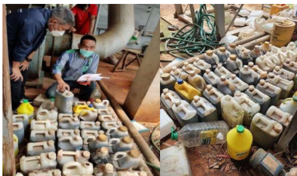
ภาพที่ 4 น้ำส้มคว้นไม้ที่ได้จากการเผาไม้เป็นเชื้อเพลิงของหม้อไอน้ำ
