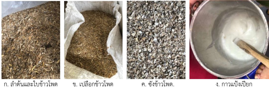
ภาพที่ 4 ต้น ใบ เปลือกและชังจากข้าวโพดที่ถูกสับละเอียด และลักษณะกาวแป้งเปียก
