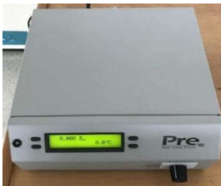
ภาพที่ 5 เครื่องวัดปริมาณน้ำอิสระ รุ่น AQUALAB PRE
