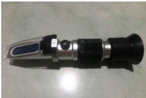
ภาพที่ 4 เครื่องวัดความหวาน Refractometer ยี่ห้อ OEM รุ่น RHB-90ATC
