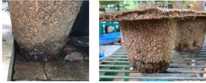
ภาพที่ 9 การเปลี่ยนสภาพทางกายภาพบริเวณก้นของกระถางชีวภาพ
